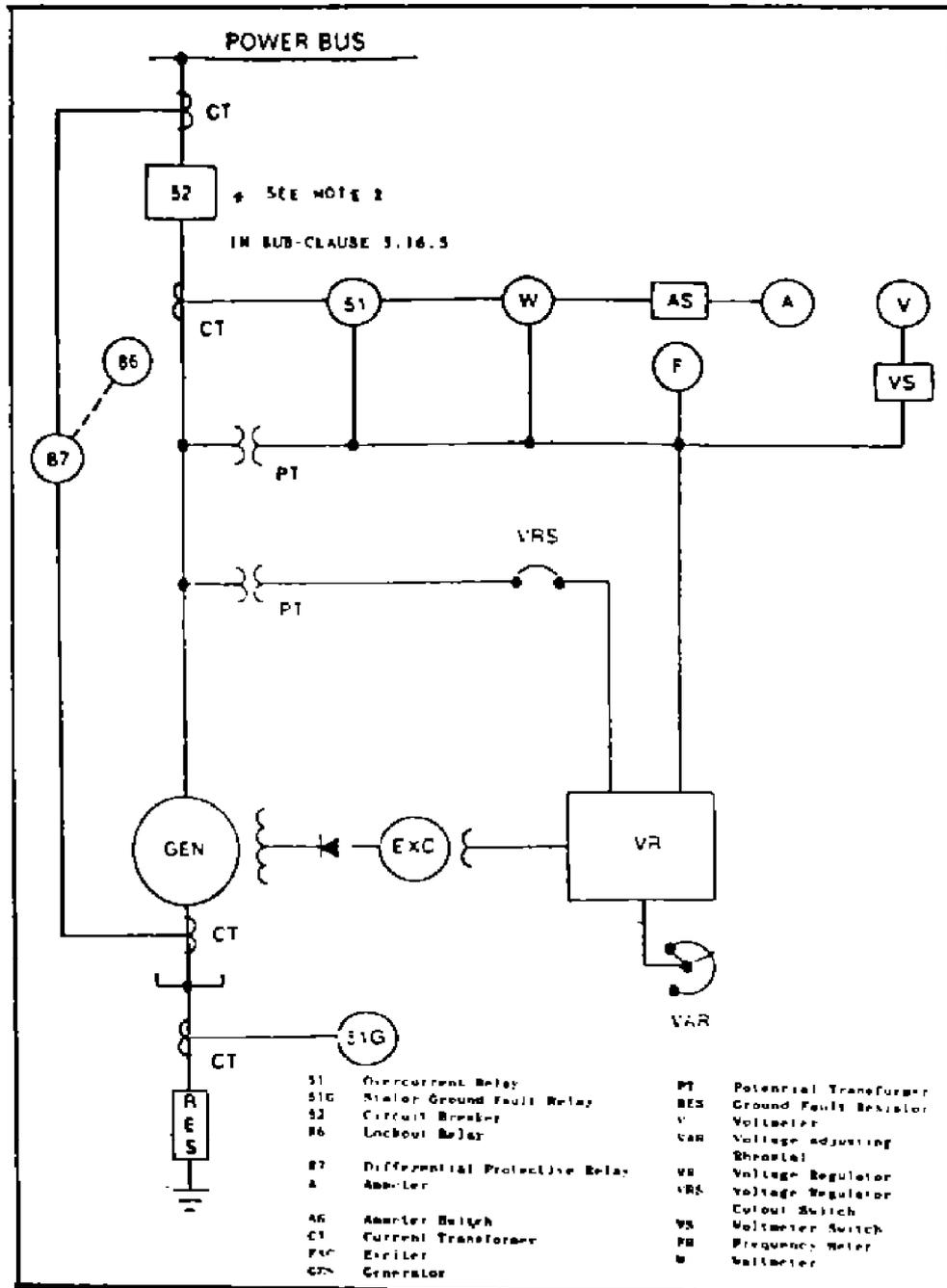
NON-PARALLEL MEDIUM VOLTAGE SYNCHRONOUS UNITS
