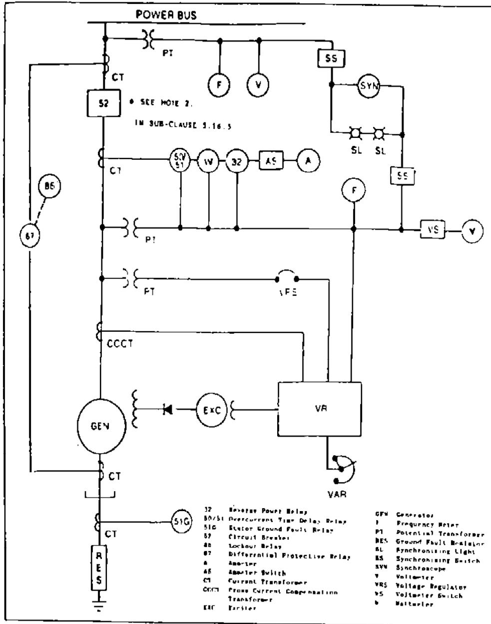
MANUAL PARALLELING MEDIUM VOLTAGE SYNCHRONOUS UNITS
